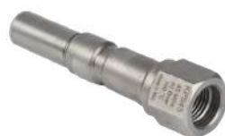
1190090100 ENCHUFE RAPIDO INOX MACHO MTM KPS45 Entrada: KCS45 Salida: G 1/4 F Presión Max: 450 Material: Acero Inox.
