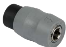
1190060100 ENCHUFE RAPIDO HEMBRA INOX KCS45 MTM Entrada: G 1/4 M Salida: KPS45 Presión Max: 450 Material: Acero Inox.
