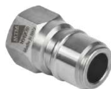
1190040100 ENCHUFE RAPIDO INOX MACHO BPS45 MTM Entrada: BCS45 Salida: G 3/8 F Presión Max: 450 Material: Acero Inox.
