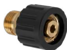
1191100150 ENCHUFE RAPIDO ROSCA 1/4H M22 MTM Entrada: G 1/4 F Salida: M22 F Presión Max: 280 Material: Latón
