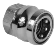
1190020100 ENCHUFE RAPIDO HEMBRA INOX BCS45 MTM Entrada: G 3/8 F Salida: BPS45 Presión Max: 450 Material: Acero Inox.
