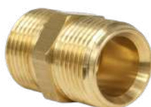
1191100157 RACORD ALTA PRESION LATON M22X15 1/4M Entrada: G 1/4 M Salida: M22 M Presión Max: 280 Material: Latón
